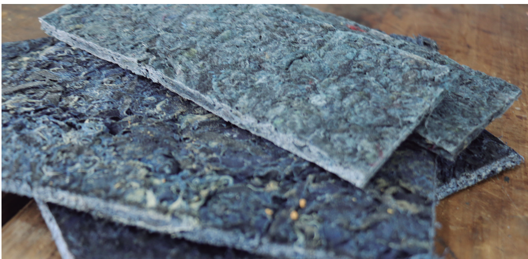
Figura 3. Placas textiles de denim. Antonella Mangialardi. Desarrolladas como soporte señalético para el edificio Raúl R. Alfonsín dentro de la beca doctoral CIC, “Técnicas sustentables aplicadas a la producción de placas utilizando desechos de la industria de la confección en la región NoBA”. Materia prima: desechos de los talleres confeccionistas de la ciudad de Pergamino.
